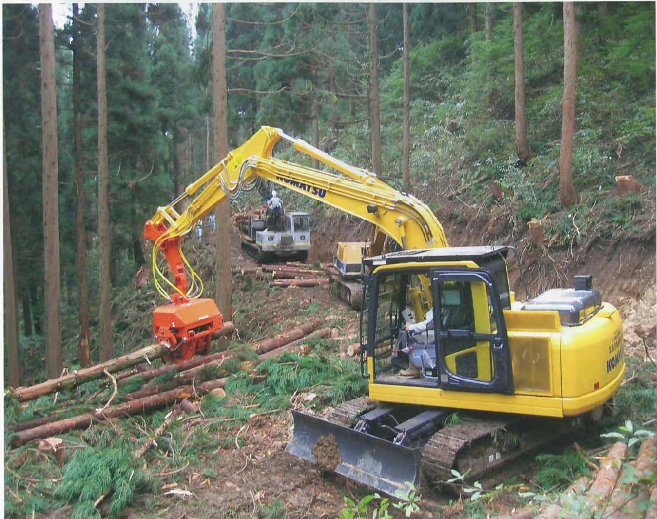
高性能林業機械による間伐材の搬出現場
