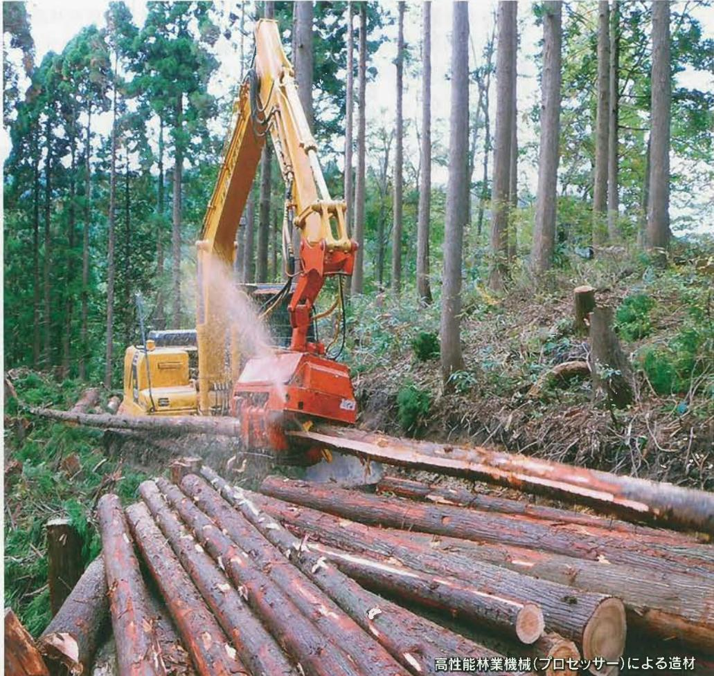
高性能林業機械(プロセッサー)による造材
