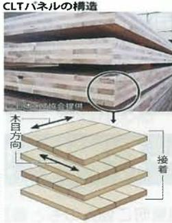
CLTパネルの構造
