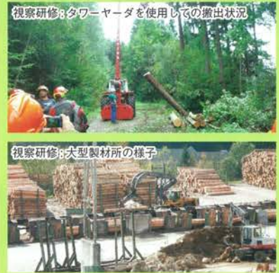
視察研修：タワーヤーダを使用している搬出状況
